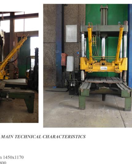
PRESS MURARO POWER 400 TONS **FULL OF BLANK HOLDER 200 TONS**
